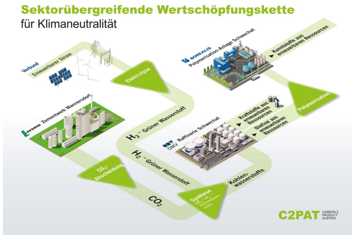
Abbildung 13: Beispiel einer sektorübergreifenden dekarbonisierten Wertschöpfungskette
